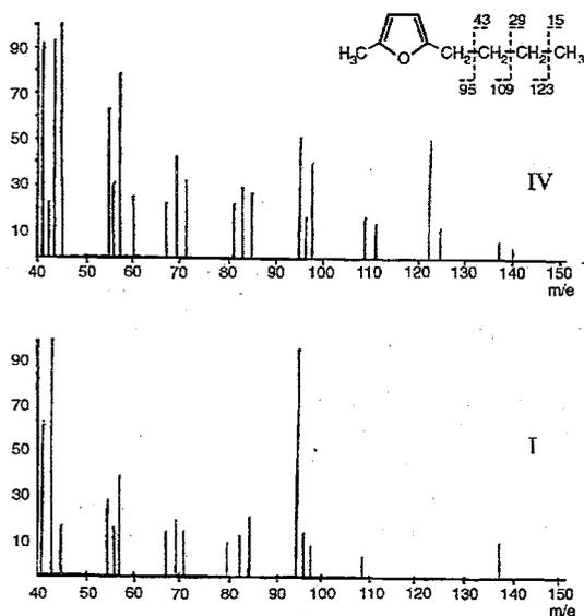
Масс-спектры соединения I ( $^{16}\text{O}$ ) и соединения IV ( $^{18}\text{O}$ )
