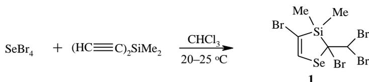
Строение соединения **1** доказано с помощью ЯМР  $^1\text{H}$ ,  $^{13}\text{C}$ ,  $^{29}\text{Si}$ ,  $^{77}\text{Se}$  и подтверждено данными элементного анализа. Спектр ЯМР содержит два сигнала протонов метильных групп и два сигнала протонов групп  $\text{CH}$ . Различие в химических сдвигах метильных групп объясняется, по-видимому, хиральностью соседнего атома углерода.
